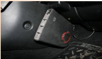
Подогреватель салонный, DEFA Termina 1350, 1350 Вт
